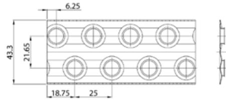
P 25 - 8 con tubi di rame da 7.94 mm (5/16"), nella geometria sfalsata 25,00 X 21.65, con alette corrugate: impiegati nel condizionamento e nella refrigerazione dell'aria (batterie ad acqua, condensatori ed evaporatori ventilati) di piccola e media potenzialità.
