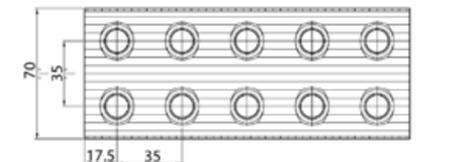
P 35 - 12 con tubi di rame diam 12 mm, nella geometria quadrata 35,00 X 35,00, con alette corrugate. Ideale per la realizzazione di evaporatori per la refrigerazione di ogni tipo.
