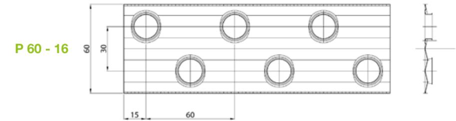
**P 60 - 16** con tubi di rame diam 16 mm, nella geometria sfalsata 60,00 X 30,00, con alette corrugate, impiegata nel riscaldamento, condizionamento e nella refrigerazione dell'aria (batterie ad acqua e vapore, condensatori ed evaporatori) di media ed alta potenzialità.
