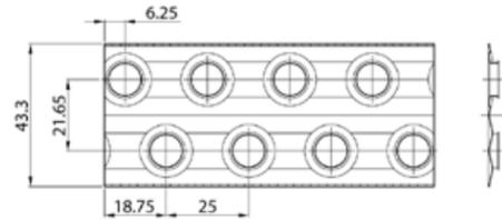
P 25 - 10 con tubi di rame da 9.52 mm (3/8"), nella geometria sfalsata 25,00 X 21.65, con alette corrugate: impiegati nel condizionamento e nella refrigerazione dell'aria (batterie ad acqua, condensatori ed evaporatori ventilati) di piccola e media potenzialità.
