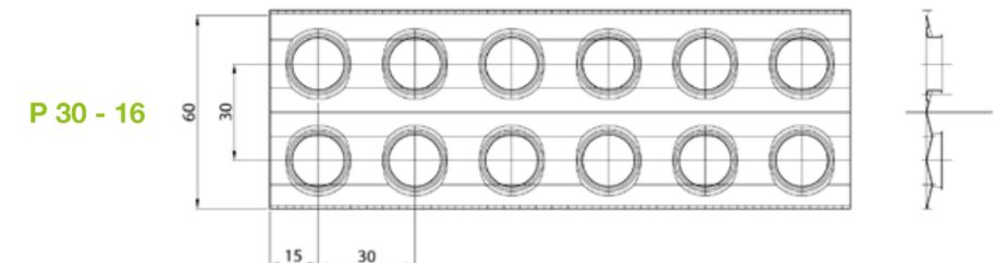
**P 30 - 16** con tubi di rame diam 16 mm, nella geometria quadrata 30,00 X 30,00, con alette corrugate, impiegata nel riscaldamento e condizionamento (batterie ad acqua e vapore) di media ed alta potenzialità.
